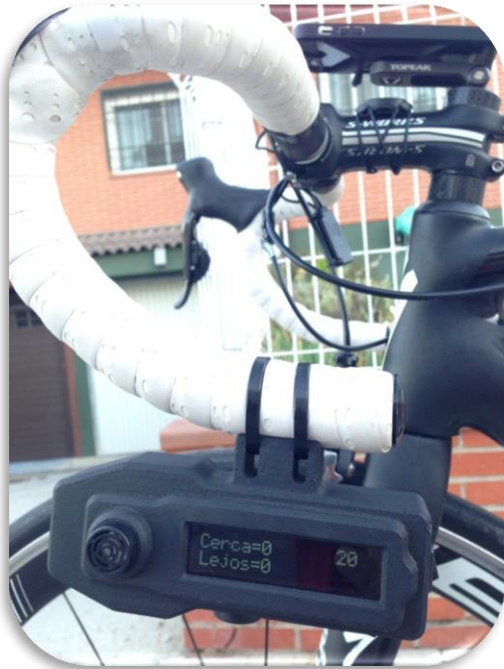
Medidor-contador láser fijado en el manillar de la bicicleta
