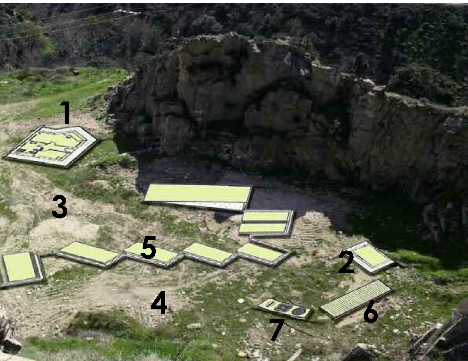
❑ **Zona de Control.** Estará formada por una caseta de 25 m<sup>2</sup> (1) y un almacén de 21m<sup>2</sup> (2) destinados al personal de trabajo, que además de ejercer labores de control, registrando los residuos que van a ser depositados, informará sobre el correcto uso de las instalaciones y la forma de depositar los residuos.
